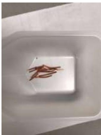
図57 マイクロ波加熱でワイヤハーネスから回収した銅線
