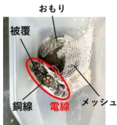
図35 混合比3:1の水酸化アルカリ溶融塩を用いて200 °Cで1時間処理し、回収した試料の様子
