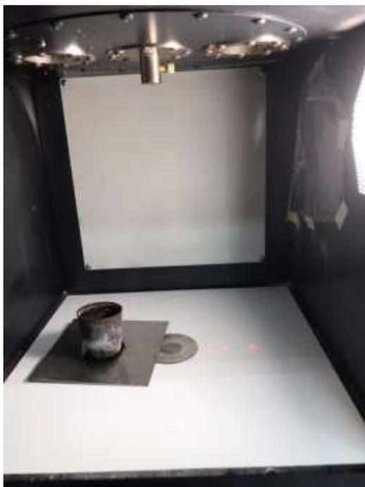
図44 マイクロ波加熱装置内に設置した坩堝
