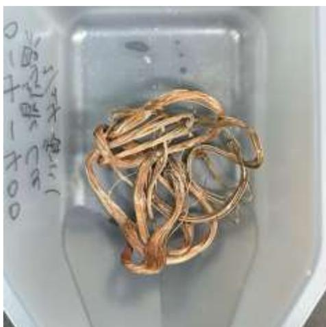
図 43 混合比 0 : 4 の水酸化アルカリ溶融塩を用いて 400 °C で 1 時間処理し、回収された銅線の様子
