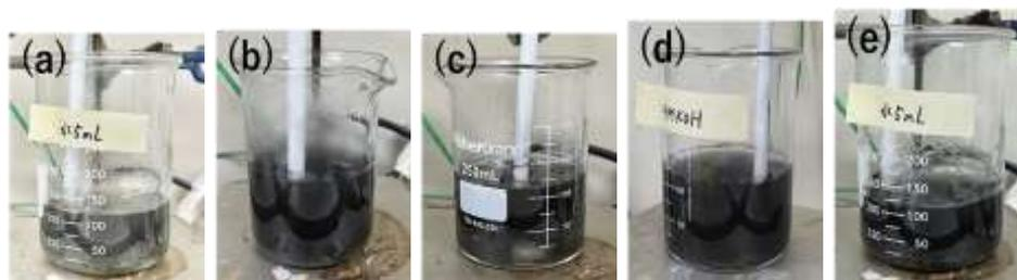
図8 各KOH添加量での熱分解によって得られた残渣を蒸留水に入れて攪拌した様子：(a) 0 mmol-10分後、(b) 5 mmol-10分後、(c) 10 mmol-10分後、(d) 20 mmol-10分後、(e) 0 mmol-20分後
